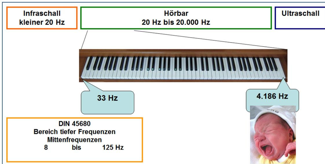
Bild 1: Frequenzbereich von Infraschall, hörbarer Schall bis Ultraschall
