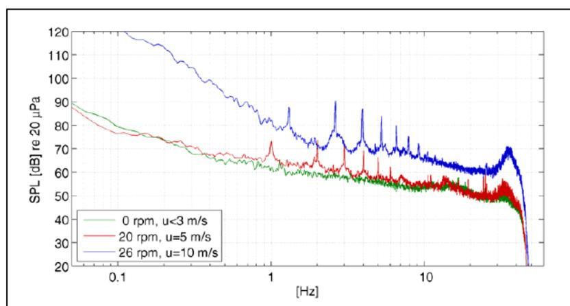
Bild 9: Frequenzanalyse des Schallsignales einer Windkraftanlage bei Hannover
