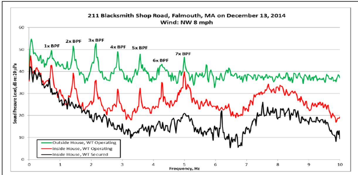
Bild 8: Frequenzanalyse eines tieffrequenten Schallsignales einer Windkraftanlage
